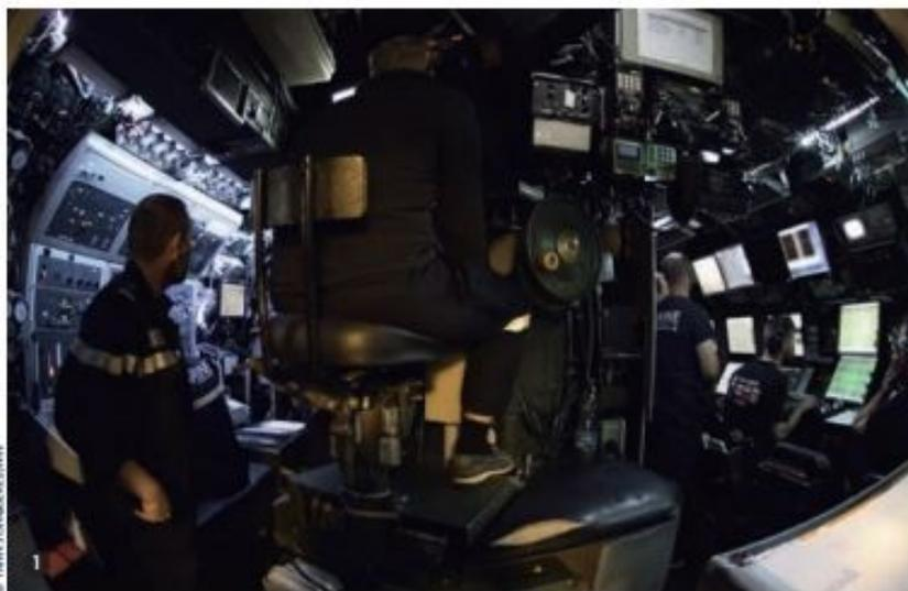
1 Le poste de conduite de la navigation et des opérations (PCNO) constitue, avec le poste de conduite de la propulsion (PCP) situé en franche arrière, l'un des points névralgiques du sous-marin. Grâce aux différents sonars,
