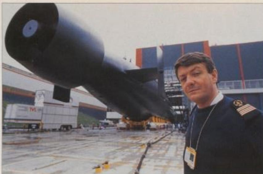
L'ICA Pierre Quinchon lors de la sortie du chantier Laubeuf du SNLE Le Triomphant en janvier 1993. Le sous-marin est sur une série de «marcheurs» permettant de le déplacer du chantier vers la forme Cachin qui servira pour sa mise à l'eau. (photo DCN Cherbourg)
