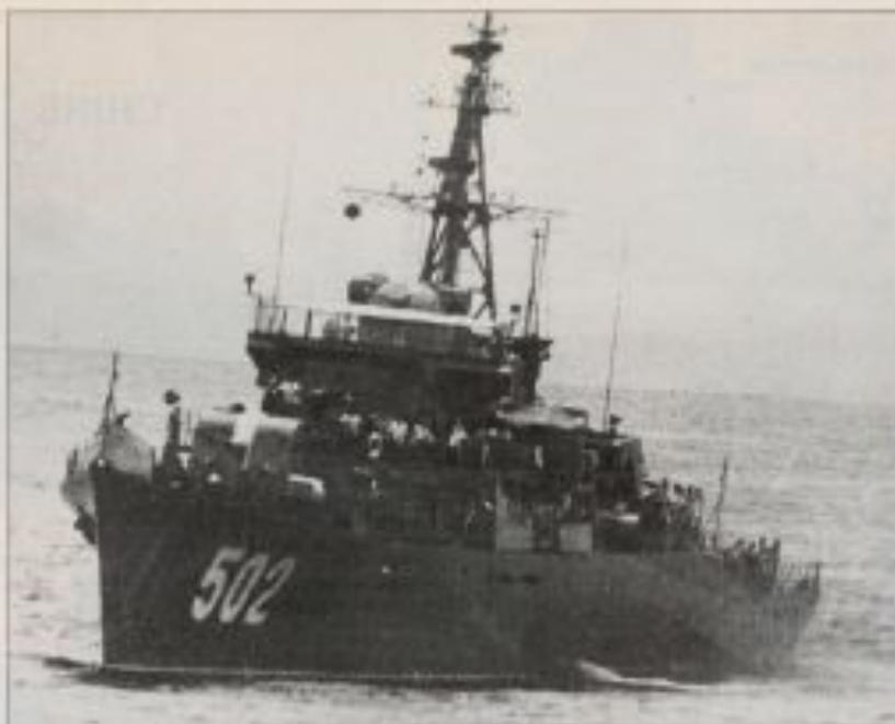
La frégate Nanchong, de type Jiangqin. Elle constitue la version chinoise de la frégate russe de type Baga et est équipée d'une propulsion à reactor diesel.
