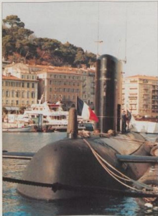
Le sous-marin français Agosta, mis en service en juillet 1977, est équipé d'un système de propulsion diesel-électrique avec deux groupes électrogènes de 850 kW, un moteur électrique de propulsion de 3 500 kW et une hélice. Ce type de sous-marins a été adopté par le Pakistan (deux) et l'Espagne (quatre). (photo : Archives Cols Bleus)
