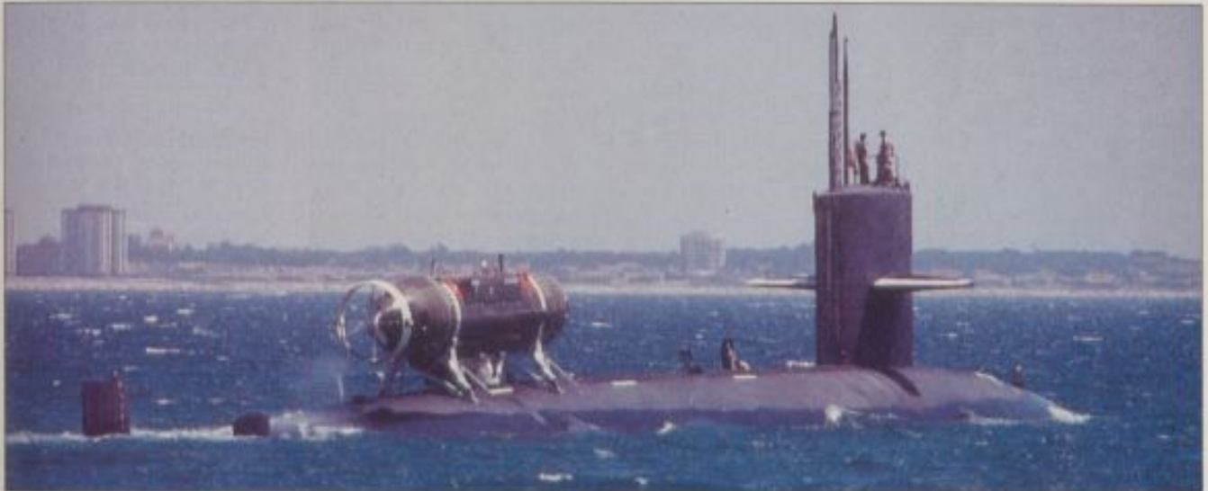
Sur le SNA américain Sturgeon, un DSRV en exercice. Né au début des années 70, ce système de sauvetage a prouvé sa fiabilité. (photo US Navy)
