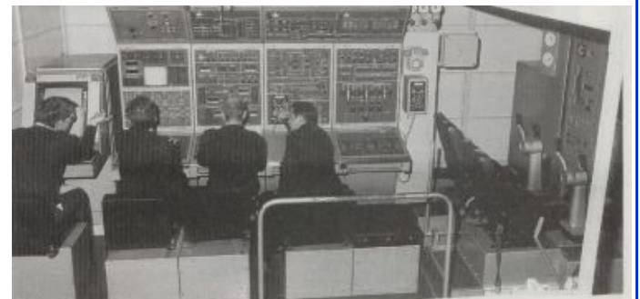
Le simulateur pilotage et sécurité plongée. Le rôle essentiel de ces plates-formes est de préparer les équipes de quart à conduire dans des situations rares et graves, que l'on ne peut « jouer » réellement à bord (photo AFP Brest).
