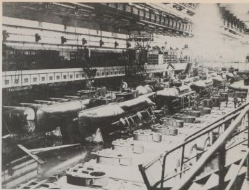
Chaîne de montage de sous-marins de poche Seehund en 1944. C'est parce qu'ils disposaient d'un grand nombre de sous-marins opérationnels et d'usines capables d'en fabriquer 25 par mois que les Allemands purent généraliser la tactique des meutes. X. Murle
