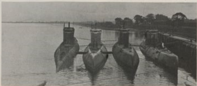
Deuxième à partir de la gauche, barres de plongée déployées, un sous-marin type XXI. Si les Allemands avaient eu le temps de mettre en service ces nouveaux sous-marins aux capacités exceptionnelles, l'issue de la bataille de l'Atlantique aurait pu être remise en cause.
