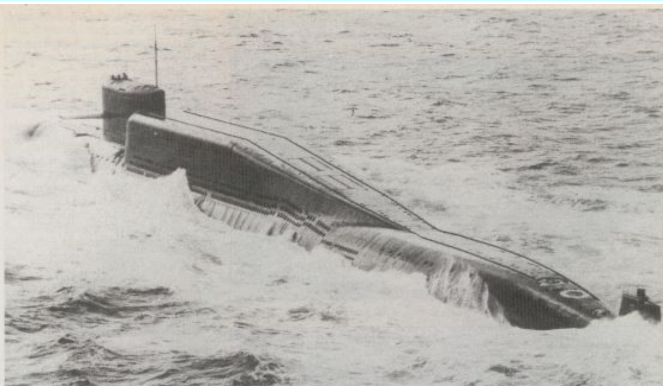
Un SNLE type Delta III. Les SNLE de ce type sont identiques aux Delta II mais ont 16 missiles SS-N-18 au lieu de 16 SS-N-8.
