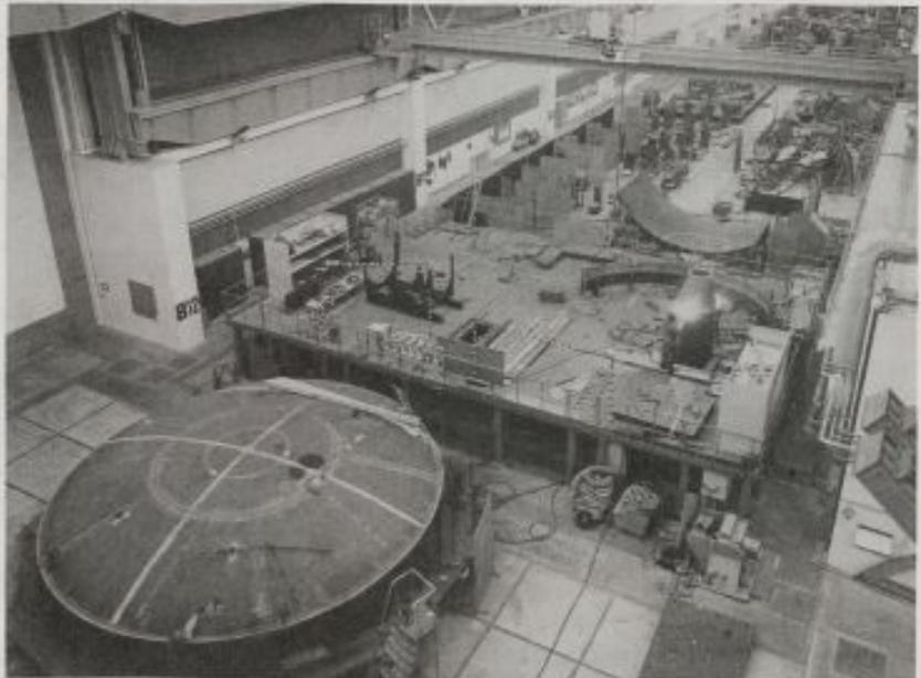
Atelier d'assemblage des éléments de coque épaisse des SNLE/NG à l'arsenal de Cherbourg (photo DCN).
