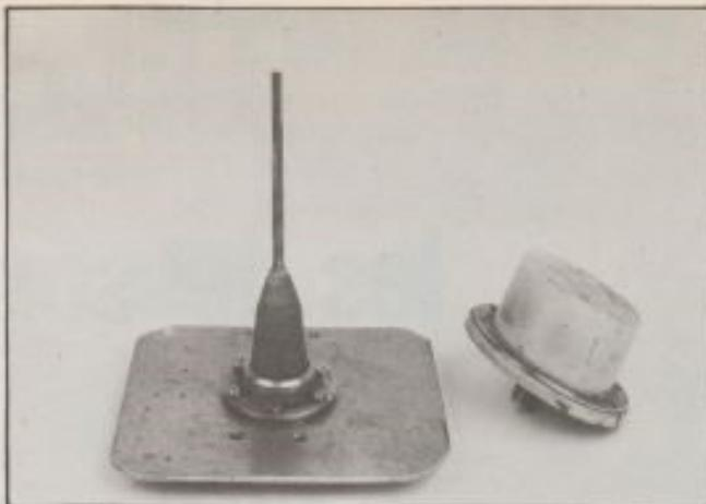
Les antennes de transmission (à gauche l'antenne son, à droite l'antenne image)
