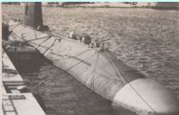
Le sous-marin Dauphin arrivé récemment à Toulon a été modifié pour servir de banc d'essai au futur matériel de détection sous-marin du SNLE NG.
