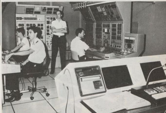
Plate-forme de simulateur de sécurité plongée des SNLE au Centre d'entraînement et d'instruction des SNLE à Brest.
