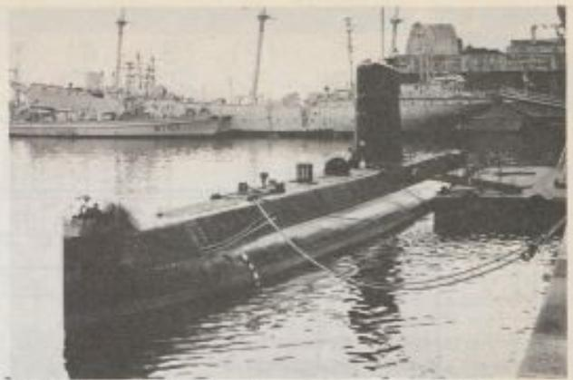
*Sirène*, sous-marin à hautes performances du type *Daphné*, 58 m, propulsion diesel électrique, un moteur électrique 1 600 ch, 13,5/6 nœuds.
