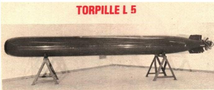
La torpille L-5 Mod. 4 P est une arme polyvalente destinée à l'attaque des sous-marins et des bâtiments de surface. C'est une torpille à propulsion électrique et autodirecteur actif-passif. Elle peut être lancée soit par bâtiment de surface, soit par sous-marin.
