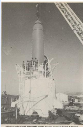
Mise au tube d'une maquette inerte dans le caisson Nemo à Toulon.
