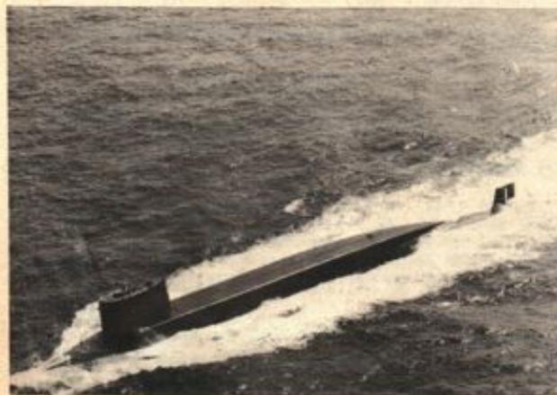
Second des sous-marins à propulsion nucléaire, lanceur d'engins, « Le Terrible » termine actuellement sa période d'essais. Long de 129 mètres, ce bâtiment déplace 9.000 tonnes en plongée. Sa vitesse en plongée est supérieure à 20 nœuds. Il transporte 16 missiles à tête nucléaire d'une portée supérieure à 2.000 km...
