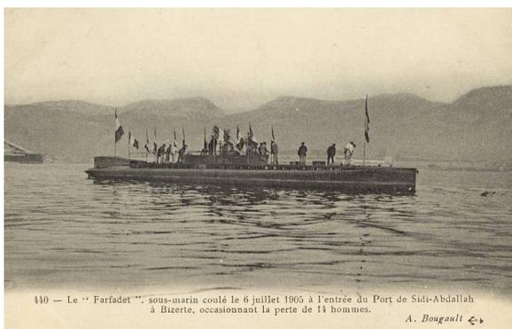
Le 06.07.1905 à 08h30 : Coule par 10 mètres dans la darse de Sidi-Abdallah, en rade de Bizerte, à la prise de plongée suite à la mauvaise fermeture du capot supérieur du kiosque.
