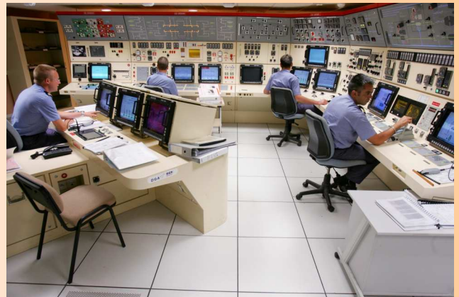
Simulateur de propulsion nucléaire du porte-avions Charles de Gaulle (SIMPAN)
