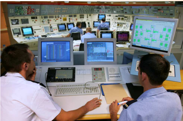
Simulateur de propulsion nucléaire du porte-avions Charles de Gaulle (SIMPAN)
