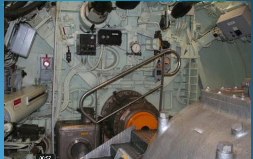
Le presse étoupe ligne d'arbre et la butée
