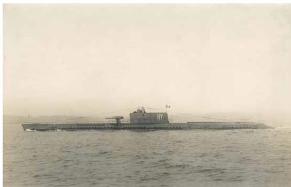
**Observations** :-Mauvais plongeur.- Défaillance des commandes électriques.- Médiocre habitabilité - Handicapés par les ¾ du combustible en soutes extérieures
