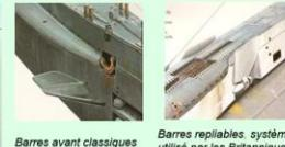
Barres avant classiques Barres repliables, système très utilisé par les Britanniques
