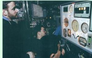
Le Commandant ne tourne plus avec son périscope pour le combat. Il est assis et a à portée de main toutes commandes du périscope placé à l'intérieur d'un puits.
